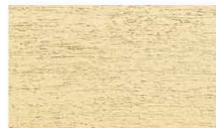
かき落とし横仕上げ (寒水石入) 下塗りを行い乾燥させた後、寒水石(3厘・100g/m 2 )を混ぜた材料で上塗りを行い、表面水が引いたら市販のスタイロフォームで横方向に模様を付けます。
