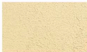
ウールローラー仕上げ (麻すさ入) 下塗りを行い乾燥させた後、麻すさ(30g/m 2 )を混ぜた材料で仕上げます。
