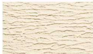
パイプローラー 横ヘッドカット仕上げ パイプローラーで模様を付けた後、表面水が引いたらパイプローラーで凸部を軽く押えます。
