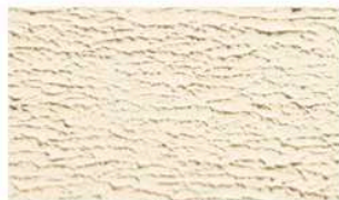
パイプローラー 横仕上げ パイプローラーで塗材を引き起こして模様を付けます。
