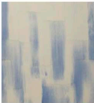
ヒキズリ縦2色仕上げ 2色塗り [コテ] 側部を使用 カラー-No. 034 + 307 (1:1)
