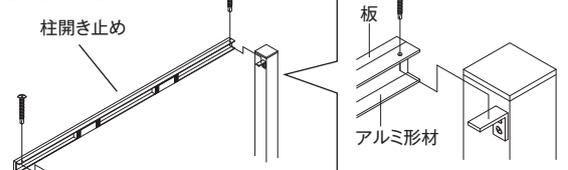
※柱が開くと板がはずれてしまうことがありますので、GL+1500mm以上の場合におすすめします。
