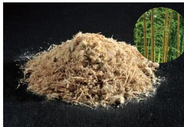
竹短繊維により防草土の圧縮強度、せん断強度が向上したためセメント系固化材を使用した従来品で問題になっていた、ひび割れを防止します。また、竹廃材を燃やさずに有効活用したことになり、CO<sup>2</sup>削減にも役立ちます。
