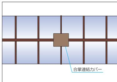
奥行方向に連結する場合に連結部のすき間を隠すカバーを用意しています。
