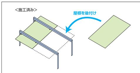
吊下げタイプで施工後に屋根を後付けする場合に追加手配してください。
