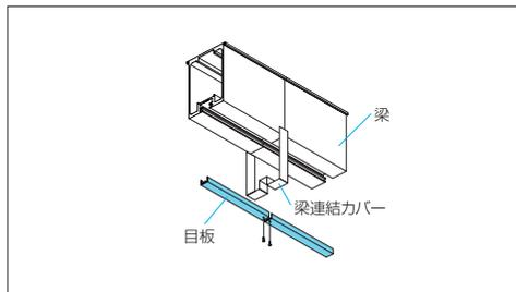
梁置きタイプの梁の連結部やネジを隠す目板を用意しています。
