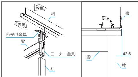
梁置きタイプで桁を柱の真上に取り付ける場合に追加手配してください。
